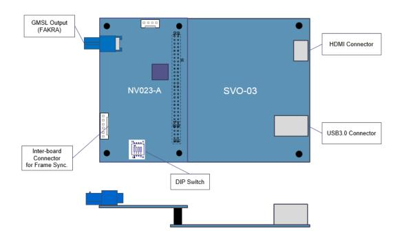
上図に本基板と SVO-03 基板のボード接続イメージを示します。図に示すように、両基板は 50 ピンのピンソケット (CN4) を介して接続されます。ねじ穴位置は両基板で共通なので、スペーサ等で両基板を固定することが可能です。
