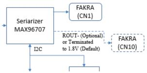
本基板では MAX96707 の OUT1+ 端子は CN1 に出力されています。また、OUT- 端子は 抵抗 R2  $(49.9~\Omega)$  を通して 1.8V に接続されています。通常は FAKRA コネクタを使用した同軸出力をサポートしています。
