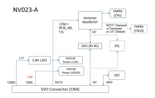
上図に本基板のブロック図を示します。本基板は GMSL シリアライザ MAX96707 を搭載しており、12bit パラレル、最大 ピクセルクロック 116MHz (最大転送レートは設定に依存) までの映像信号をサポートします。 パラレル信号の入力コネクタは SV シリーズ共通のインタフェースとなっており、SVO-03 等弊社基板と直結しての使用が可能です。出力コネクタは FAKRA 規格のコネクタ(シングルエンド転送)を実装しています。
