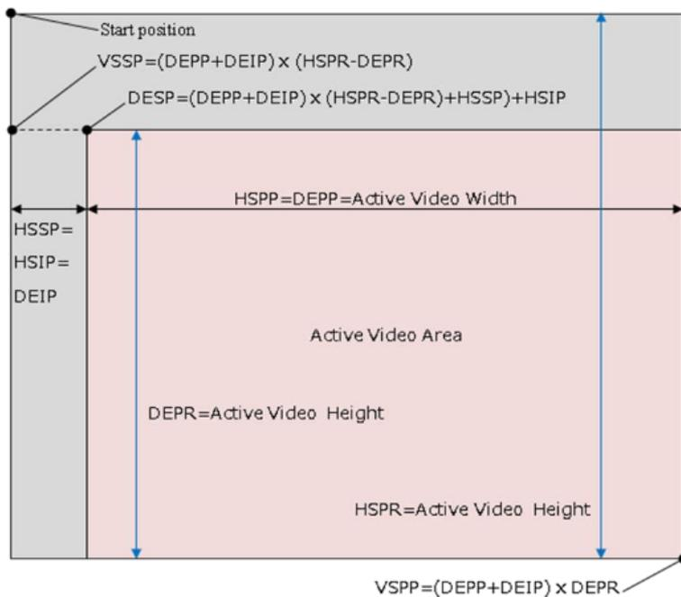
HS\*\* = DE\*\* としたときの、パラレル信号の出力イメージを上図に示します。
