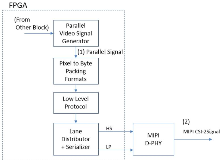
パラレル信号と MIPI CSI-2 信号のタイミングの関係を下図に示します。下図において (1) Parallel Signal のタイミングチャートに示したタイミングパラメータには、Device Setting ダイアログにある同名の設定項目が反映されます。パラレル信号のタイミングパラメータの名前および機能はパラレル版 SVO-03 ボードの設定項目と同じです。(2) MIPI CSI-2 Signal は出力データとなる MIPI CSI-2 信号を示し、(1)(2) 間の矢印がタイミングの対応を示します。例えば、FE (Frame End) パケットはパラレルの VS (VSync) 信号の立下りで出力されることを示しています。
