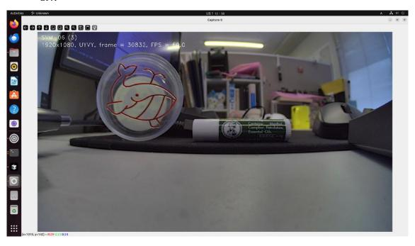
マルチチャンネルカメラキャプチャ用ソフトウェア「v4l2Capture」は、SVM ボードで取り込まれた映像を表示、保存する機能を持つ、SVM ボード動作サンプル用 GUI ソフトウェアです。最大 4 チャンネルまでのデバイスを同時に動作させることができます。本ソフトウェアは C++ 言語ソースコードの形で提供されます。
