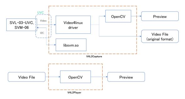
Linux 版 SDK を使用した SVM ボードのキャプチャ環境の構成図を上図に示します。UVC を使用したキャプチャは図中に橙色で示した「V4L2Capture」によって動作し、映像信号のプレビュー、キャプチャと I2C 通信が可能です。キャプチャされた映像ファイルは入力されたデータ構造が非圧縮で格納されており、「V4L2Player」によって再生することができます。このほか、I2C 通信や SVM ボードの設定を行うためのユーティリティも SDK に含まれています。
