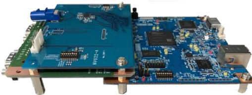
使用例としては、現在 FPDlink III-DS90UB954 ボード FPI-954 と SVM-MIPI を使用して、車載カメラ画像を PC に取り込んでいます。この環境に CAN-IF ボードを追加できます。
